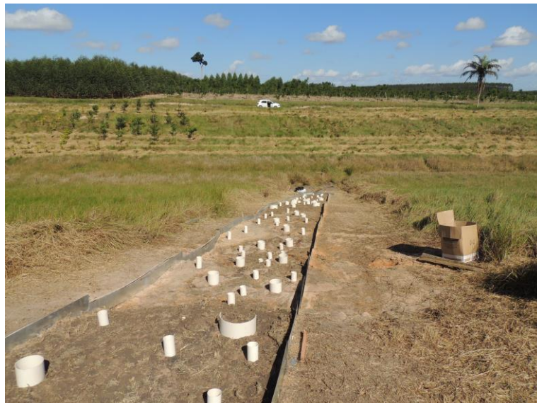
Figura 7 – Canos de PVC simulando rugosidade de troncos de árvores
